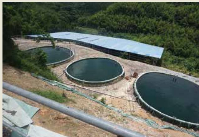
شکل ۷: تانک‌های اسیدی و حوضچه‌های رواناب استحصال عناصر HREE در معدن Longnan جنوب چین
